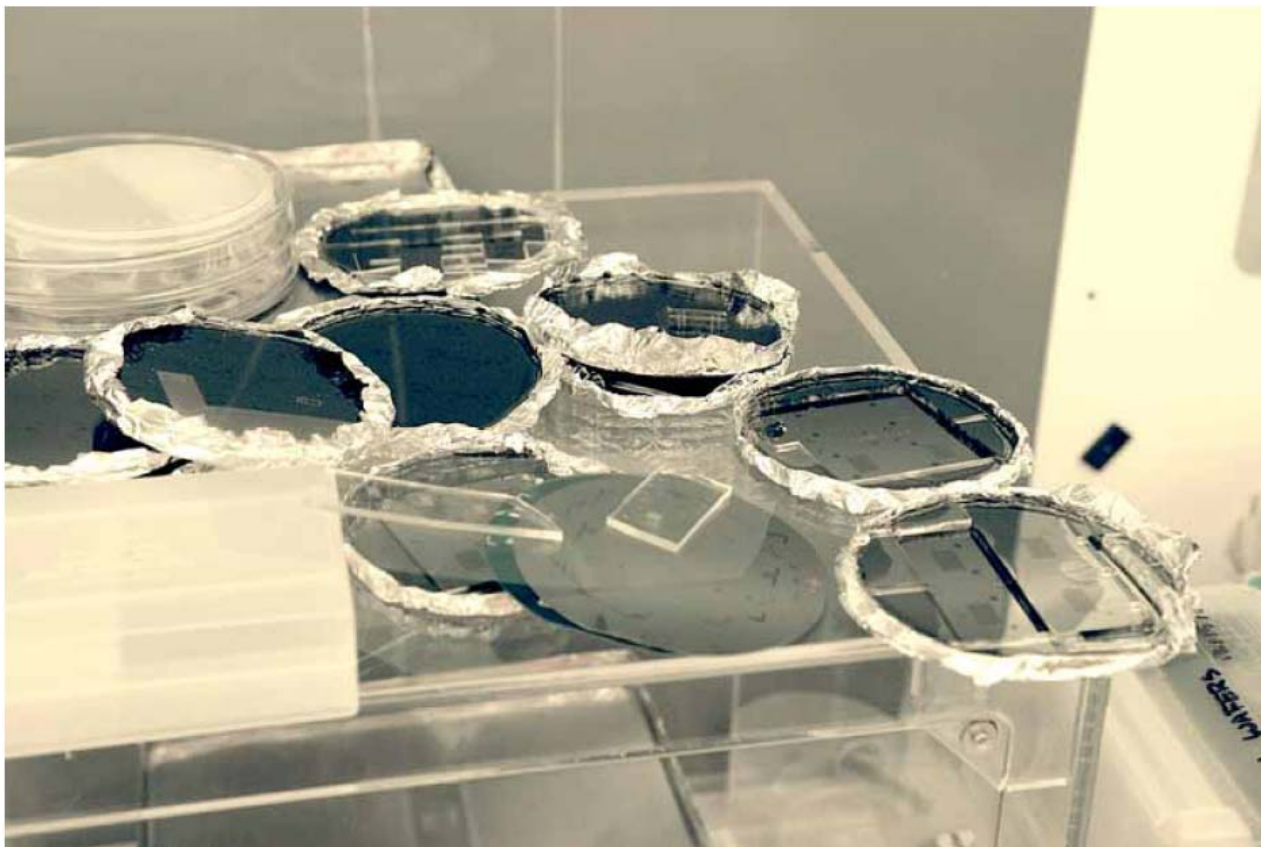
PDMS öntőformák, félkész eszközökkel (University of Minneapolis, MN)
